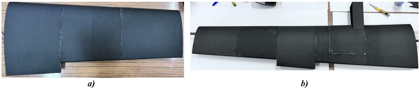
Fig. 5. Asamblarea tronsoanelor aripii: a) asamblarea tronsoanelor 3-4-5; b) asamblarea tronsoanelor 1-2-3-4-5.
