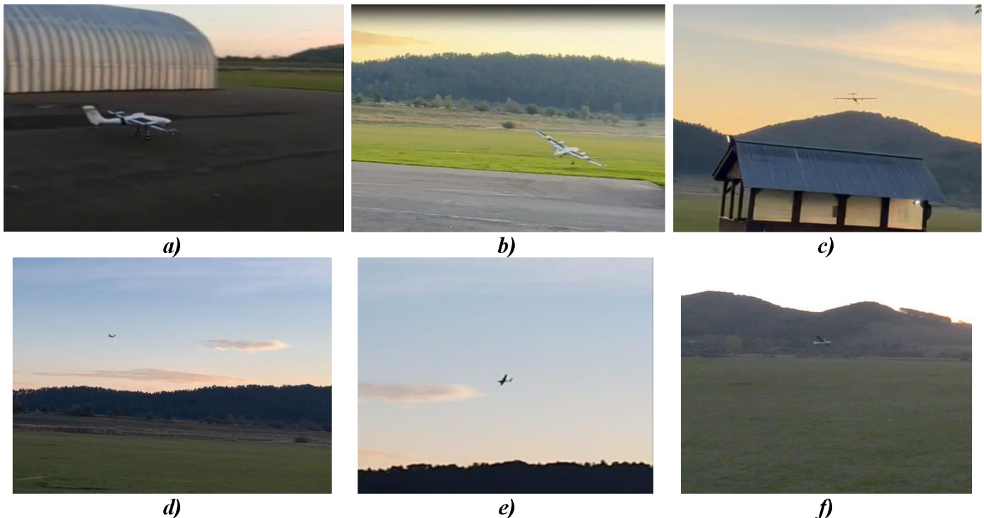
Fig. 19. Zborul modelului experimental UAV: a) rularea la sol ; b) desprinderea de la sol; c) urcarea la plafonul de zbor; d) zborul de croazieră (orizontal); e) pregătirea unui viraj; f) aterizarea la sol.
